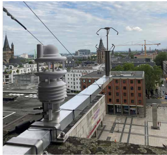
Abbildung 11: Positionierung des Messaufbaus an der Südfassade des Kölner Doms (links) und Detailsicht (rechts) der Wetterstation (vorn im Bild) sowie des 3D-Anemometers (hinten) in 1,5m Abstand zur Fassade © Fraunhofer IBP
