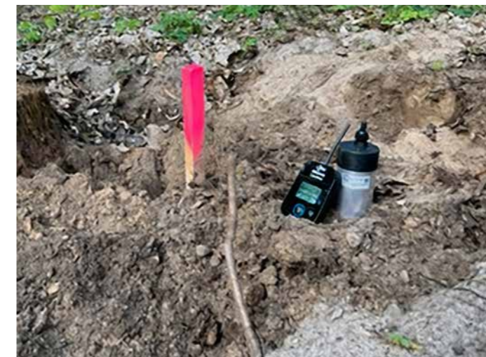
Abbildung 6: Ausbringung eines Bodenfeuchtigkeitssensors © SPSP, Katharina Matheja
