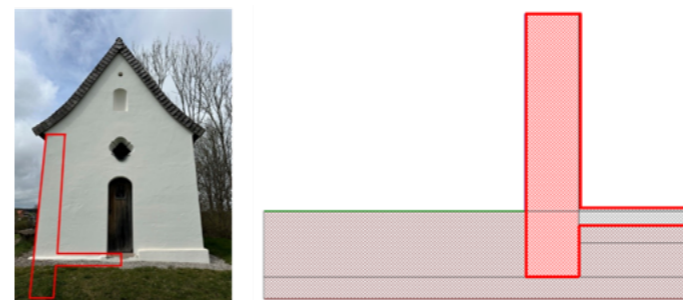
Abbildung 3: Südansicht der Frauenbergkapelle Sufferloh (links) mit schematisch eingetragenem Bauteilbereich für die Simulation (rote Linien) und Abbildung des Bauteilaufbaus mit angrenzendem Erdreich in WUFI® 2D (rechts) © Fraunhofer IBP
